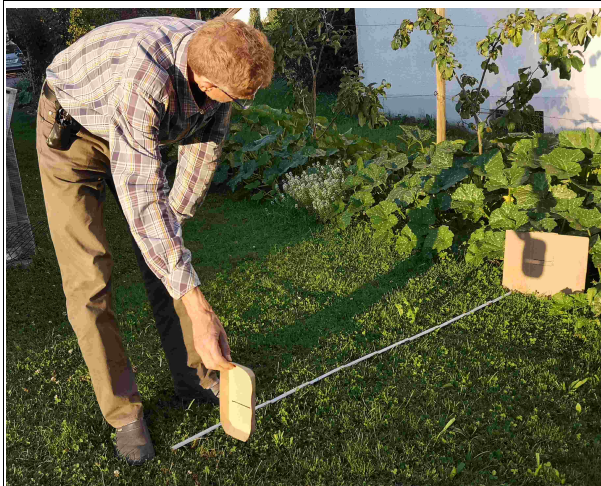
Experiment mit Schlitzblende, Projektion in 2 m Entfernung (Zollstock liegt am Boden), kurz vor Sonnenuntergang
